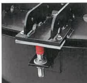
Koncová klapka DN 1400 z oceli 1.0038, lakovaná, varianta s šikmým víkem a tlumičem dorazu.
