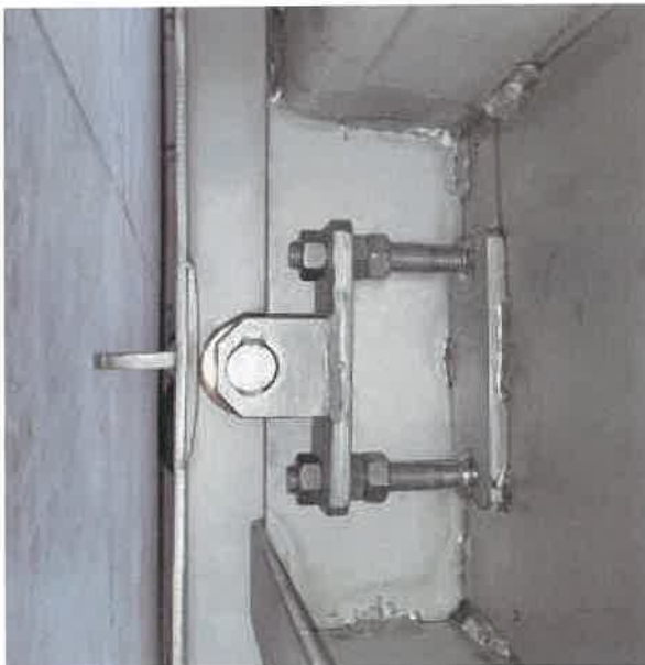
Obr. 3 – seřizovací šrouby kladky přítlaku desky
