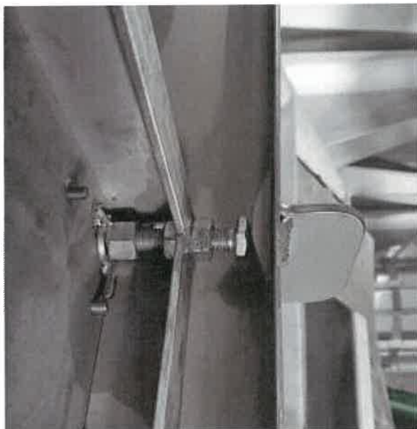
Obr. 2 – seřizovací šroub přítlaku desky
