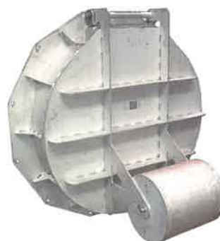
Koncová klapka DN 1200 z ušlechtilé oceli s protizávažím, určená k připevnění hmoždinkami na stěnu
